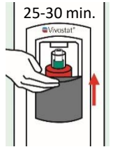
3. Sluit de afscherming, druk op de knop en de verwerking wordt gestart
