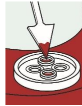
4. Nettoyer la valve avec les tampons Sugi
